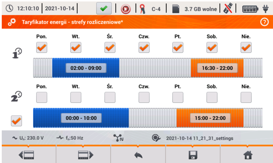
Rys. 35. Taryfikator energii – Ustawienia stref rozliczeniowych w taryfie strefowej.
