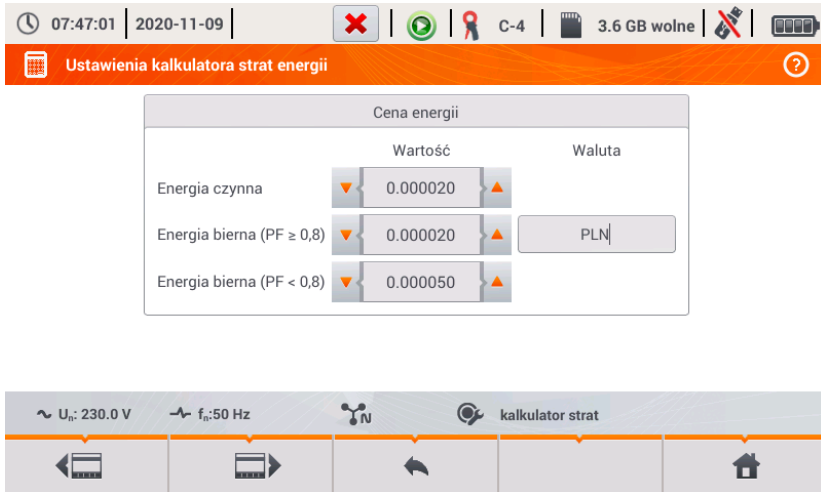
Rys. 51. Analiza strat energii – ekran konfiguracyjny 2
