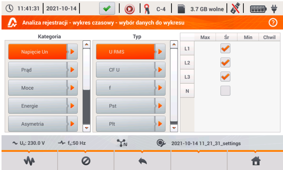
Rys. 24. Analiza rejestracji - wybór parametrów do wykresu czasowego.
