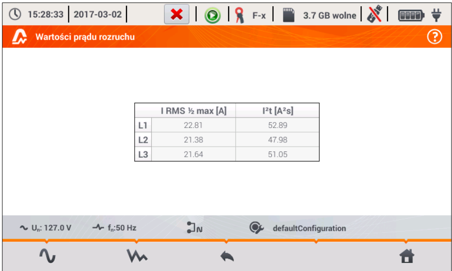
Rys. 44. Prąd rozruchu – parametry charakterystyczne.
