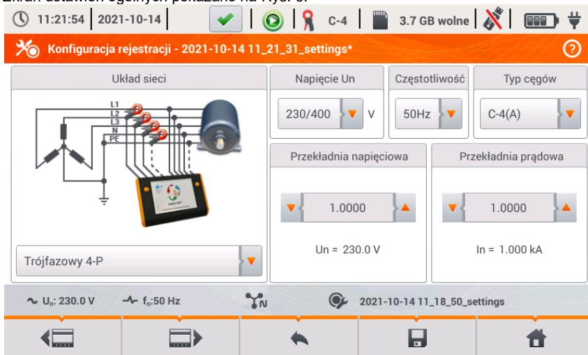
Rys. 6. Konfiguracja rejestracji - ustawienia ogólne.
